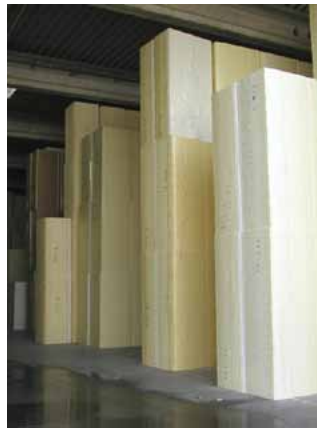
Zwischenlager der produzierten Blöcke, welche bis zu 6 Wochen gelagert werden
